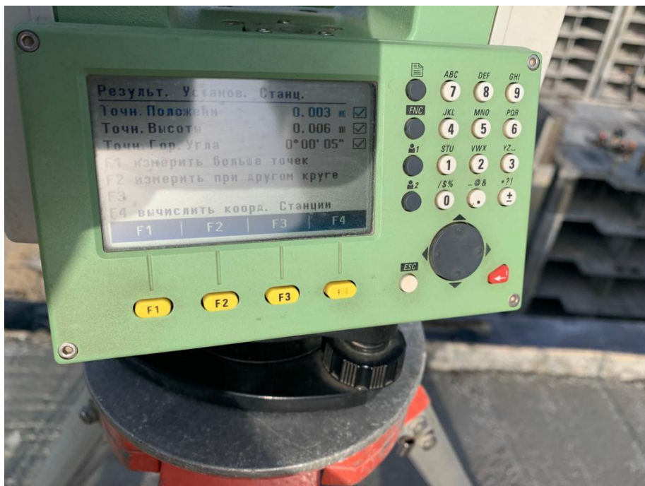
11-сурет – Leica TS06 аспабының экрандық көрінісі
